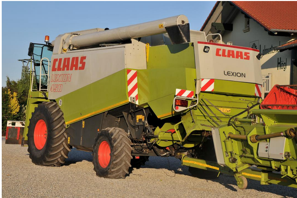
Das Bild zeigt die gelben Seitenreflektoren, die hintere elektronische Rundumleuchte sowie die Heckmarkierungstafeln am Mähdrescher
