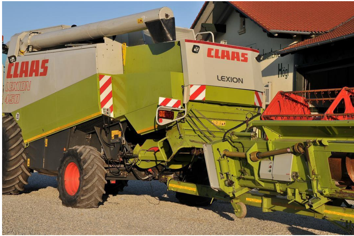
Das Bild zeigt am oberen linken Bildrand den Seitenscheinwerfer zur Ausleuchtung der verbleibenden Restfahrbahnbreite
